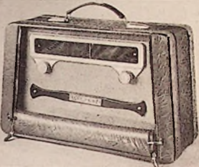
Der 6-Kreis-5-Röhrensuper Lembeck-„Kamerad“ gehört in die Reihe der Vorstufensuperhets
